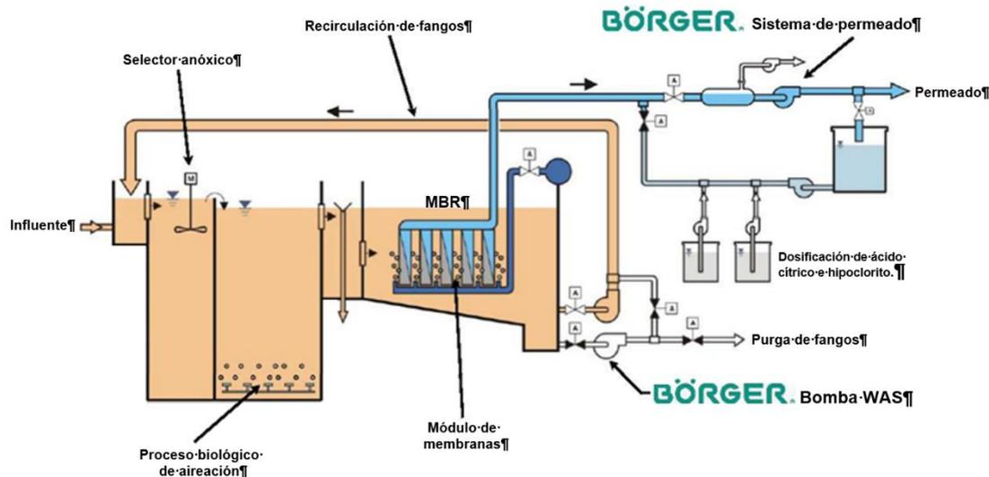
Esquema de funcionamiento de la tecnología de membranas MBR y ubicación de las bombas lobulares rotativas de Böerger.
